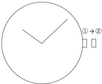
リューズを②の位置まで引き出し回転させ、時間と分を設定してください。時間と分を設定後にリューズを①の位置まで押し戻すと時計が動き出し、時刻の設定が完了となります。
